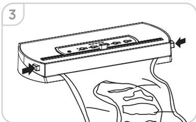
Cuando el proceso haya finalizado, presione los botones de desbloqueo de los laterales para abrir la tapa y retirar la bolsa.
